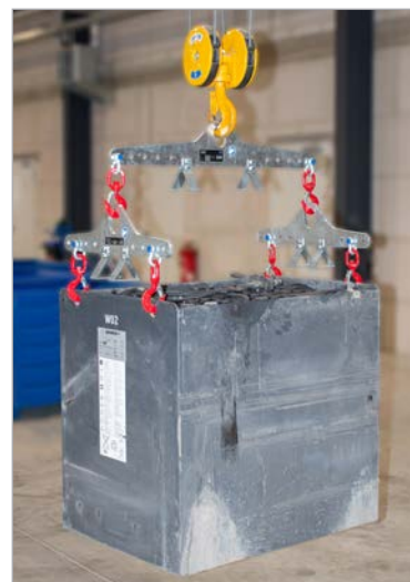
Kombination aus mehreren Traversen zur H-Traverse
