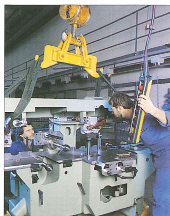
Jetzt kommt der stabile Vorschubbalken dazu.
