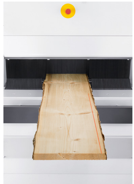
Laser zur Schnittanzeige: sehen, was gesägt wird
