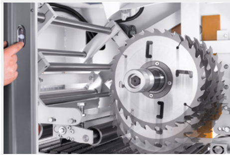
Elektrische Höhenverstellung der Sägewelle: hoher Bedienkomfort
