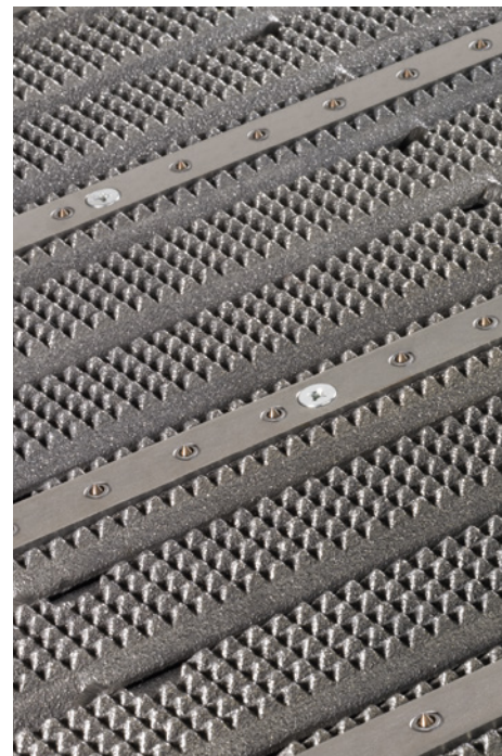
Spikes: seitliche Führung für exakte Parallelität auch bei verzogenen Hölzern
